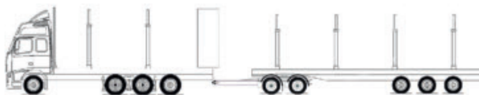
Figur 10. ST-kranbil. Lastbil med kran, dolly och trailer.
