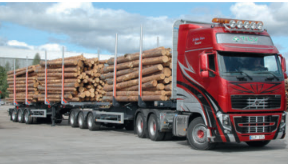
Figur 9. ST-dragbil består av en 3-axlad dragbil, följd av en 3-axlad link och en 3-axlad trailer.
