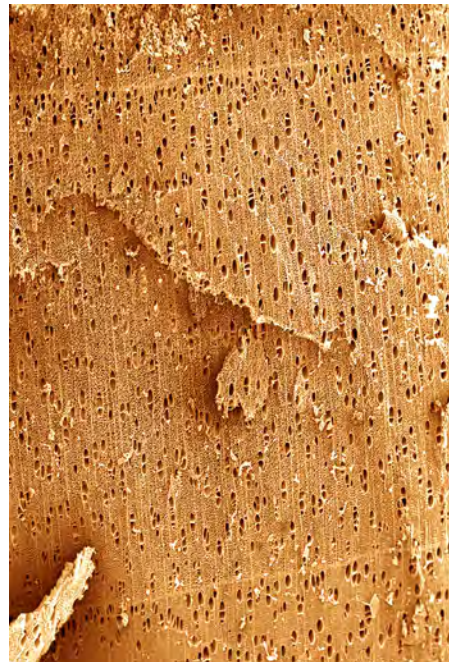
Figur 8:4. Tvärsnitt av björkved i förstoring. Foto Linköpings Universitet/Lövträinstitutet
