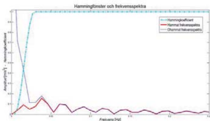
Figur 12. Hammingfönster (Hammingkoefficient), Hammat respektive ohammat frekvensspektra. Hammingfönstret tar bort frekvenser som beror på att mätserien fourieranalysen görs från inte slutar på samma värde som den börjar.
