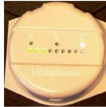
Figur 2. Accelerometrar av märket HealthVib i förarstolen. Sittplatta med signalkonditionering. Datainsamling med VibIndicator.
