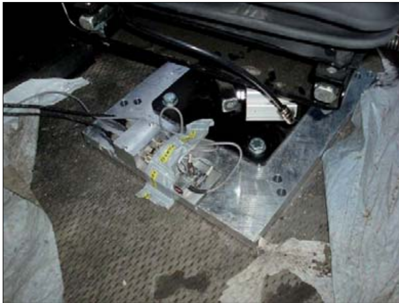
Figur 1. Tre stycken accelerometrar av märket Endevco 7562-HS i hyttgolvet.
