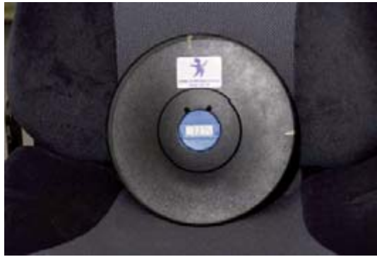
Figur 2. Accelerometrar av märket HealthVib i förarstolen. Sittplatta med signalkonditionering. Datainsamling med VibIndicator.
