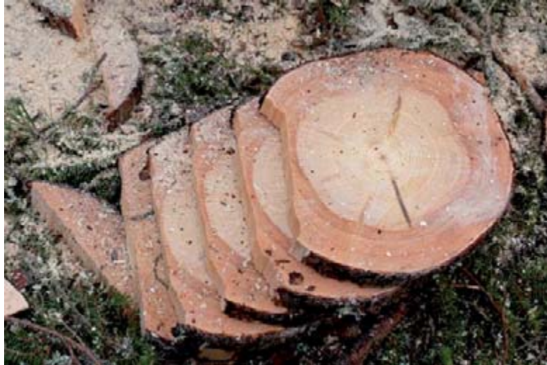
Figur 4. Illustration av trissmetoden. Trissorna är kapade ur samma stockände och genom att summera trissornas tjocklek kan kapsprickans längd uppskattas.
