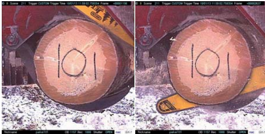
Figur 2. Bilder från höghastighetskameran som illustrerar mätningen av kaptid. I vänstra bilden har svärdet just gått in i barken och ett brunt spånsprut syns. I den högra bilden har genomkapning just skett och trissan är avskild från stocken.
