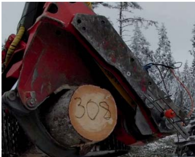
Figur 3. Pulsgivaren monterad för mätning av sågmotorns varvtal.
