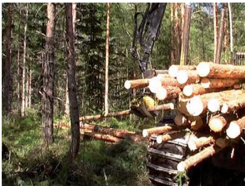
Figur 1. Bilden visar hur föraren lägger ihop virke för att kunna föra ett större knippe till vagnen, vilket minskar antalet krancykler och uppställningsplatser (med griptilt).
