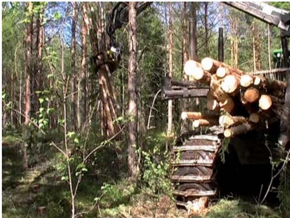
Figur 3. Bilden visar hur föraren tar ut knippet på högkant mellan stammarna och därmed undviker att skada dem (med griptilt).
