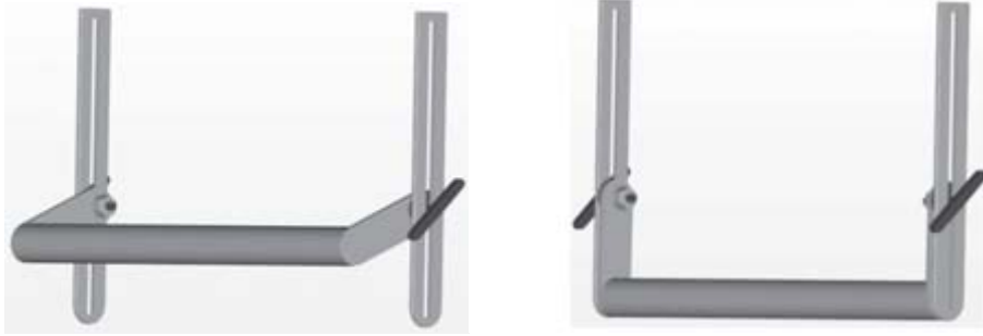
Figur 28. Fotstödet som justeras med hjälp av 2 skruvar.
