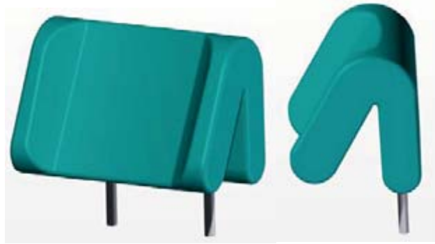
Figur 31. Nackstödet i ISO-vy samt i profil. Här syns hur nackstödet går att fälla ut.
