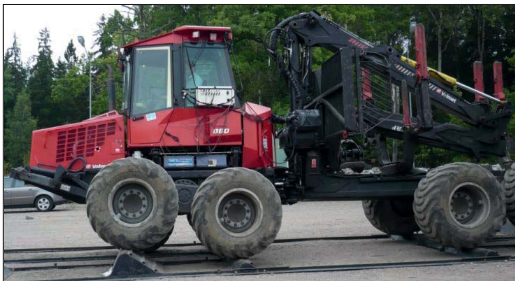
Figur 8. Skotaren på vibrationsbanan.
