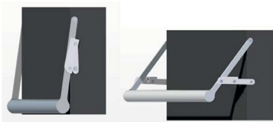
Figur 29. Fotstödet infällt och utfällt.
