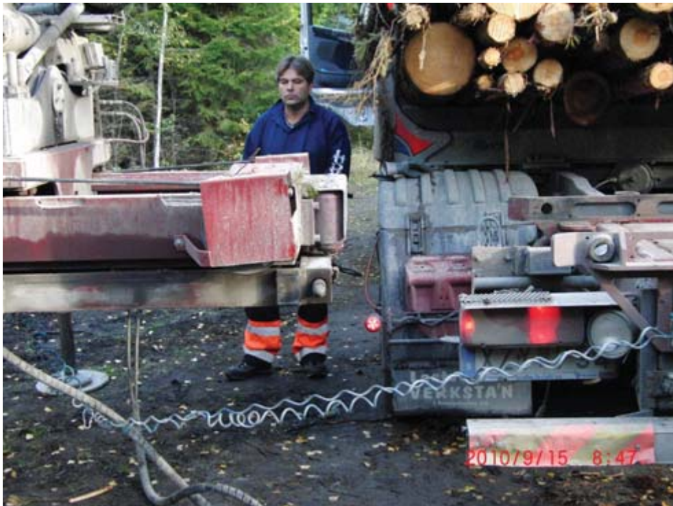
Figur 4. Föraren Ove Backelin, fjärrstyr kranen med en liten låda på magen. Notera hur långt stödbenen kommer från bilen.
