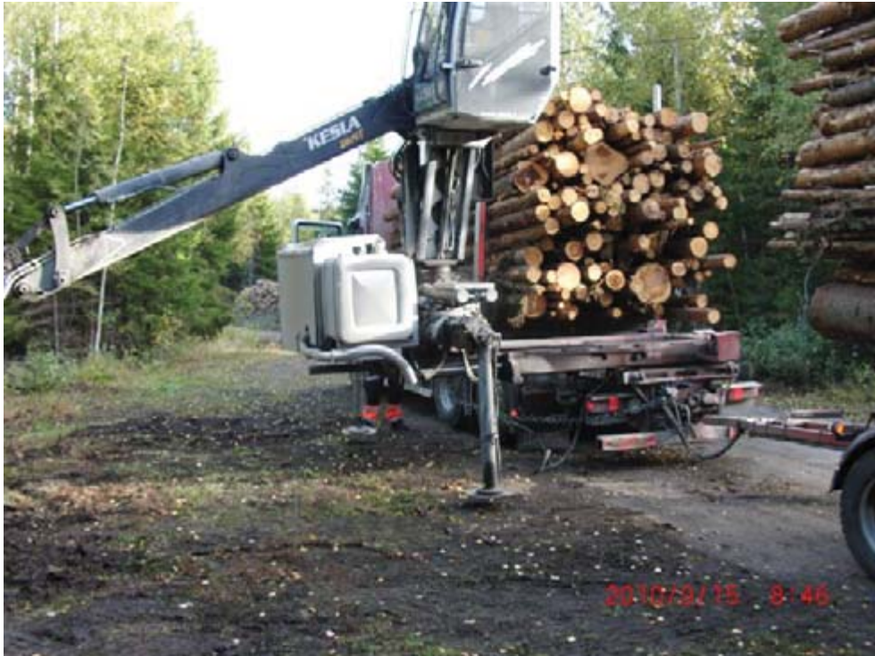
Figur 2. Avmontering av kran. Kranhuvud och grip fungerar här som ett stödben.
