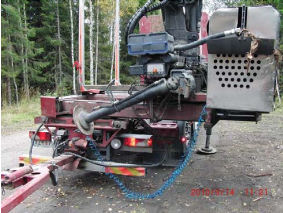
Figur 1. Montering av kran. Här syns den specialtillverkade kranavställaren som nu har vridits 90 grader i förhållande till ekipagets längdriktning.
