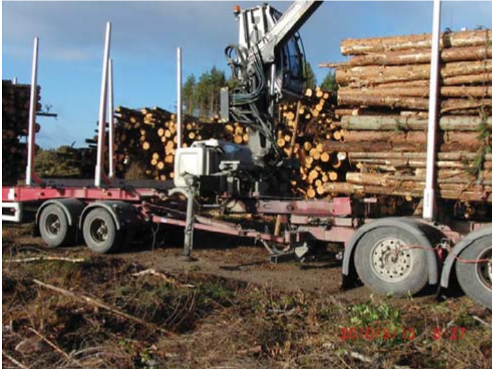
Figur 3. Föraren flyttar kranen i längsled för att möjliggöra lastning av den bakersta traven. Observera att stödbenen inte nuddar marken på bilden.
