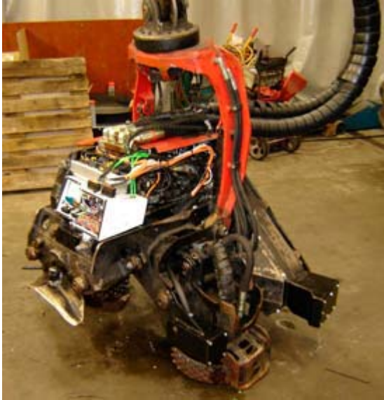
Figur 6.1. Kopplingslådans placering i aggregatet.
