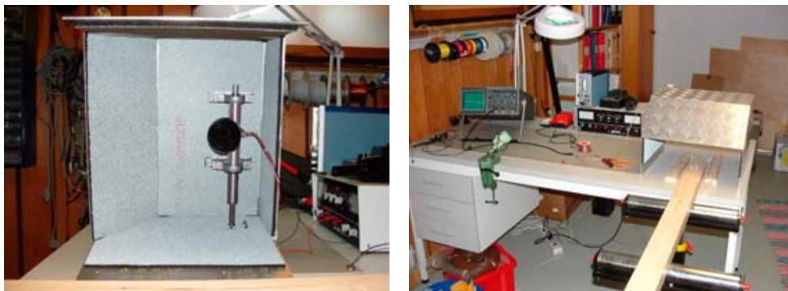
Figur 2.2 Mätuppställning för laborietest av längdmätning med mikrovågor.
