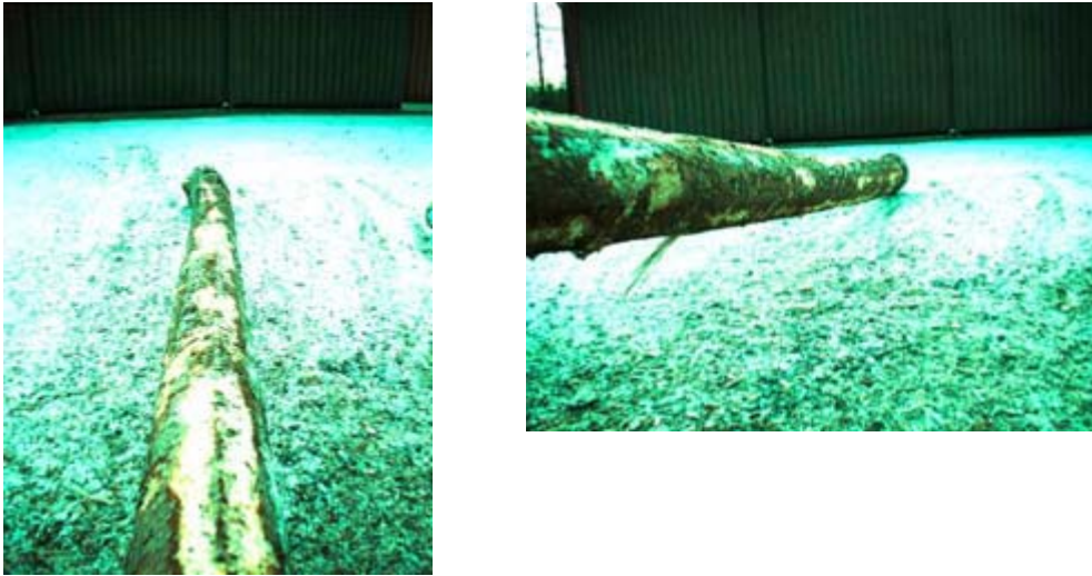
Figur 4.2. Bilder från krökkamerorna. Bakgrundens variation i ljushet, färg och textur gör det extremt svårt att automatiskt särskilja stockens konturer.
