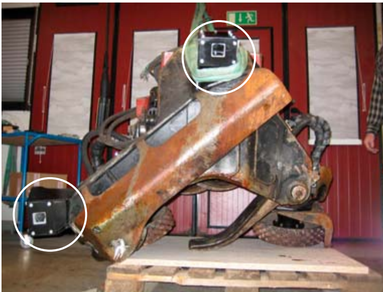
Figur 4.1. Krökkamerornas placering på skördaraggregatet.
