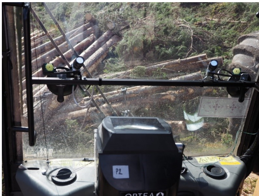
Figur 3. Eye-trackingkameror (och HUD) monterade i maskinens framruta.
