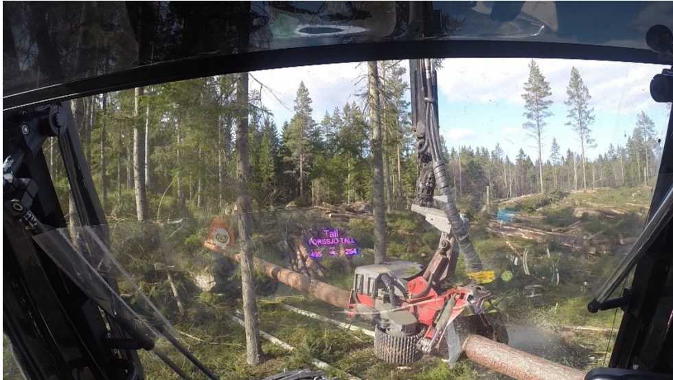
Figur 2. Apteringsinformation projicerad på stråldelaren. Foto Optea AB.
