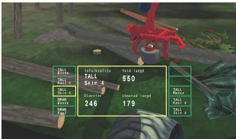
Figur 9. Head-up display vid sortering i fack. (Egen bild).
