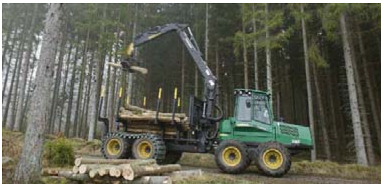
Figur 2. Skotaren kör virket från avverkningsplatsen till bilväg för vidare transport. Figuren visar en Timberjack 1110D ( www.timberjack.se ).
