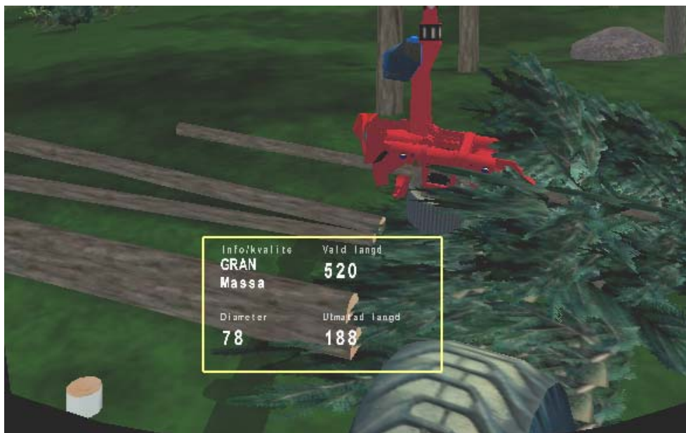
Figur 8. Head-up display vid Manuellt förarbete där automatiken är igång. (Egen bild).
