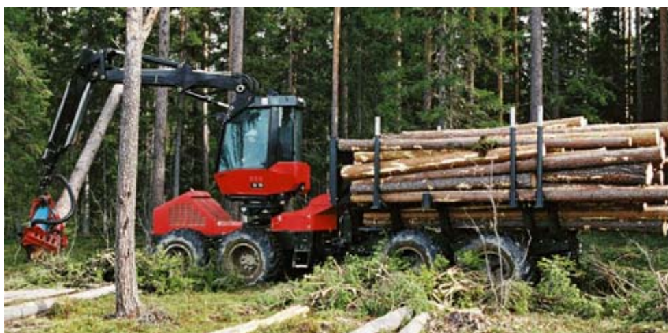
Figur 3. Drivaren, här en Valmet 801 Combi, är en kombinerad skördare och skotare (www.komatsuforest.com).
