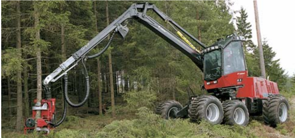
Figur 1. En skördare, modell Valmet 901.2, i arbete vid en slutavverkning ( www.komatsuforest.com ).
