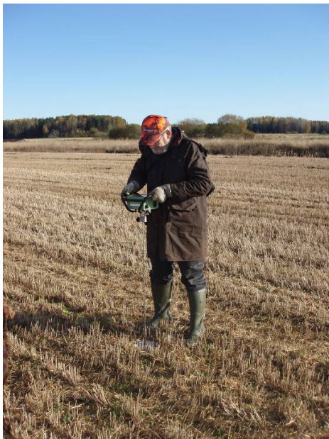
Figur 5. Mätning av konmotstånd med hjälp konpenetrometer.
