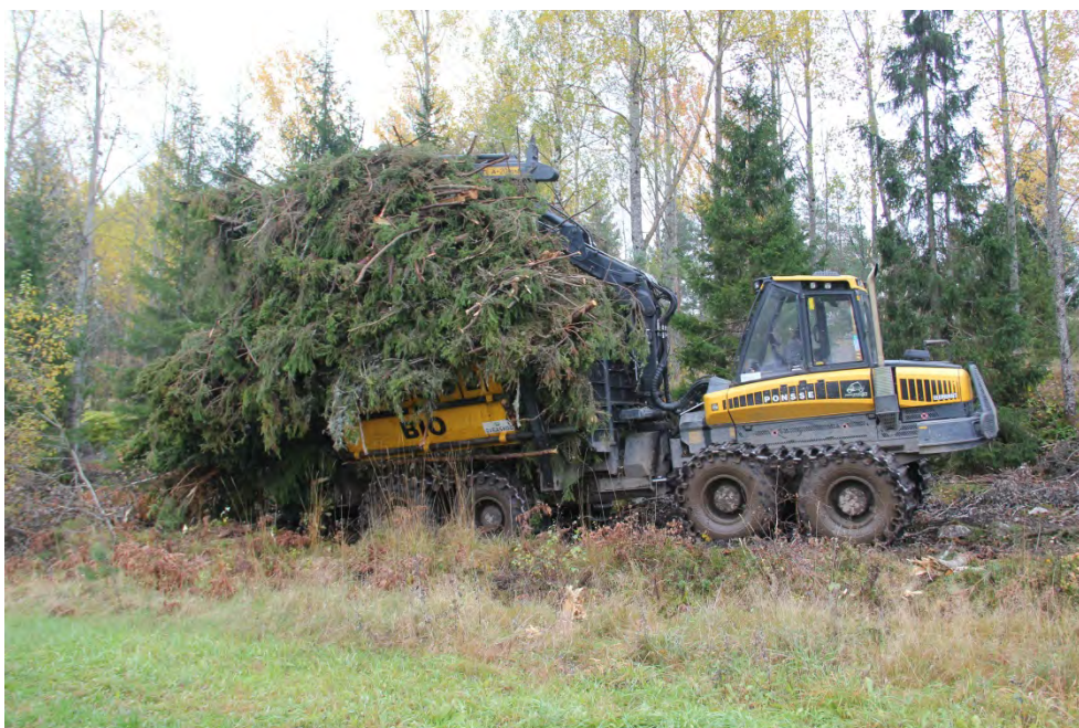
Figur 3. Basvägskörning med komprimerat grotlass.
