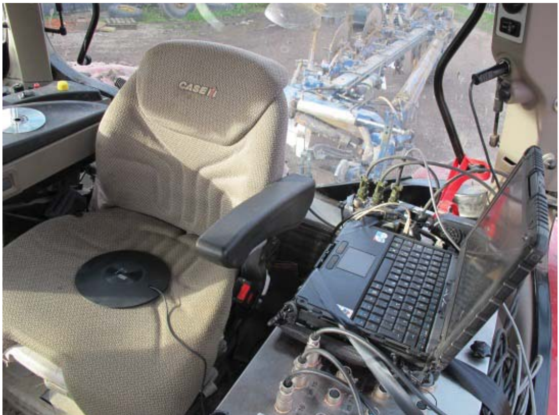
Figur 1. Placering av sittplatta för mätning av helkroppsvibrationer med och utan luftkudde.
