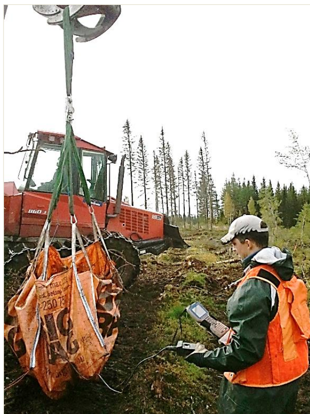
Figur 9. Det uppkomna spillet vid skotning av stubbarna samlades in manuellt och vägdes med en hängvåg som lyftes med skotarens kran.
