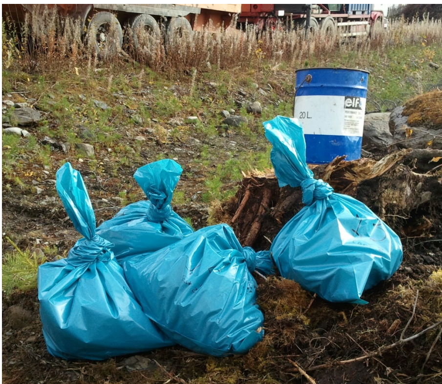
Figur 8. Prover för fukt- och askhaltsbestämning av stubbkrossen togs med 20-litershink och förvarades i plastsäckar.
