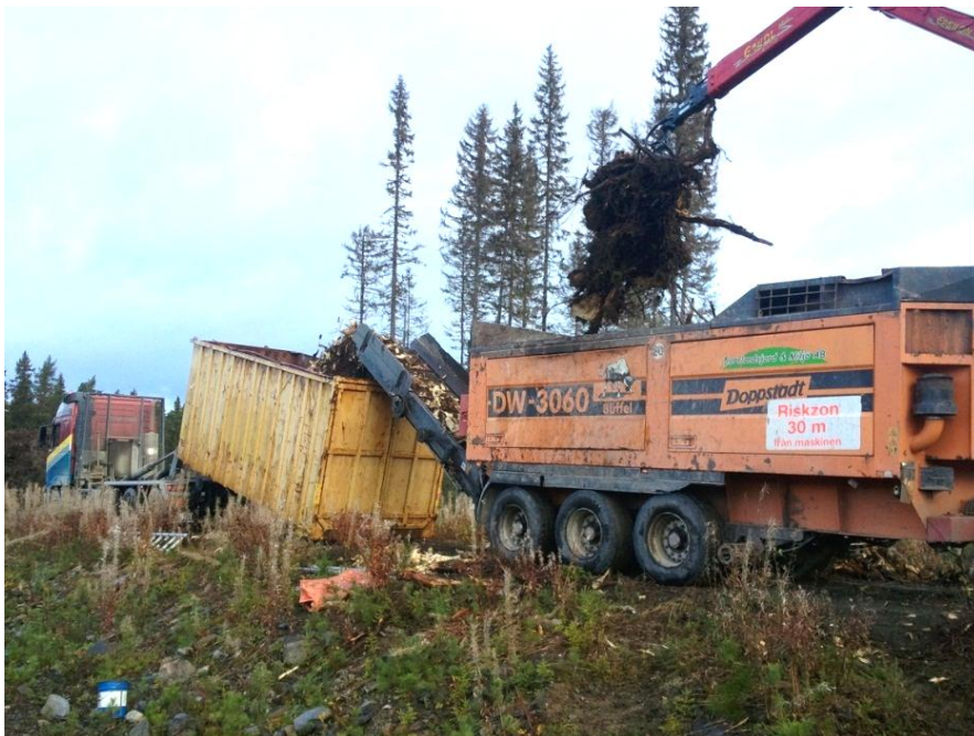
Figur 7. De skördade stubbarna krossades och matades direkt ner i containrar som sedan transporterades till invägning vid en fordonsväg.
