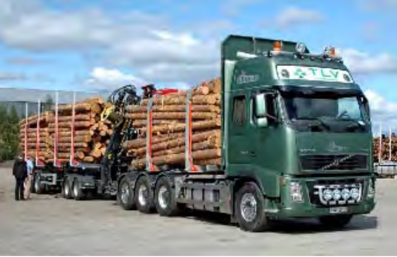
Figur 8. ST-kranbil består av en 4-axlad bil med drivning på 3 axlar, följt av en 2-axlad dolly och en 3-axlad trailer.
