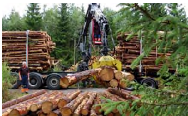
Figur 12. Intermercatos kranvåg är monterad mellan rotator och kranpets. Instrumentet för avläsning av vikten är placerad i kranhytten.
