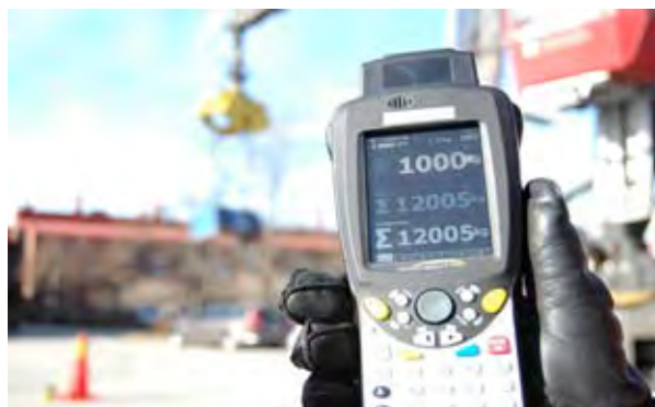
Figur 12. Intermercatos kranvåg är monterad mellan rotator och kranpets. Instrumentet för avläsning av vikten är placerad i kranhytten.
