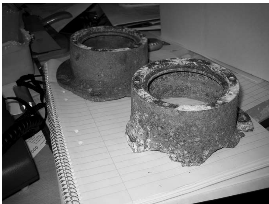
Figur 7. Korroderade navkapslar av aluminium.
