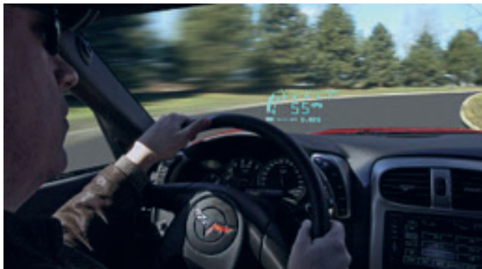
Bilden visar GMs HUD för personbilar. Den kan redan i dag beställas som tillval.
