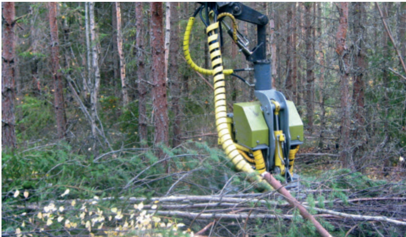
Bracke C16 i klen skog. Detta är ett av ett 20-tal aggregat för skogsbränsle som finns på marknaden i dag. Foto: Helmer Belbo
