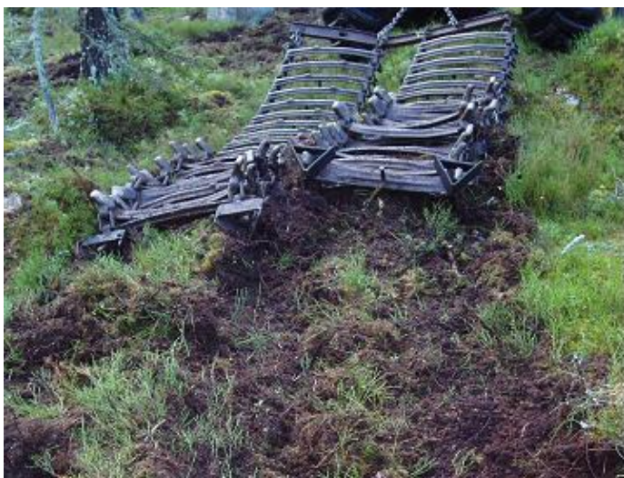
Figur 2. Markberedning med dubbelvikta skotarband. Foto: Peter Wallin, Boxholms Skogar AB.
