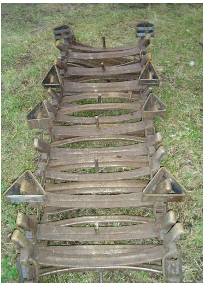
Figur 3. Dubbelvikta skotarband som försetts med "järnplogar". Foto: Peter Wallin, Boxholms Skogar AB.
