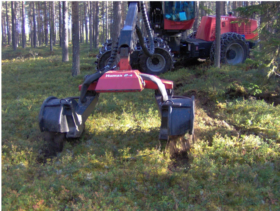
Figur 1. Markberedning med markberedningsaggregatet Humax 2-4 i försök nr 4, Vindeln.
