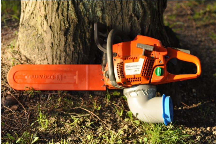
Figur 1. En motorsåg utrustad för uppsamling av spån testades för att samla material för bestämning av den hyggstorkade grotens ingångstorrhalt.
