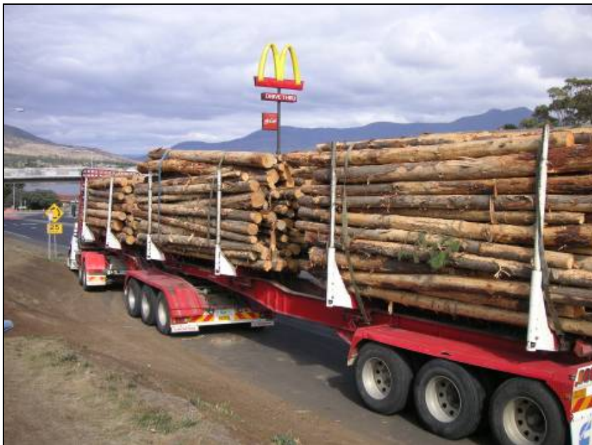
Figur 4. Easyloader TriAxle-TriAxle med 68 tons bruttovikt.
