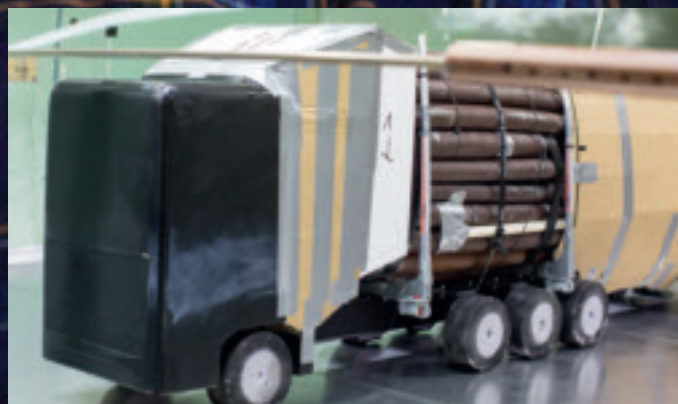
En prototyp för framtiden. Med denna utrustning minskar bränsleförbrukningen med 7–8 procent.
