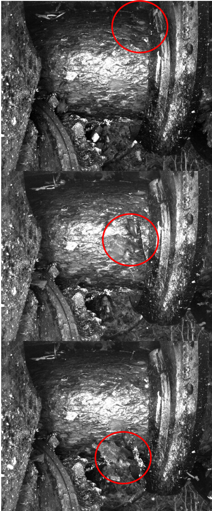
Figur 20. Exempel på barkflagor (inringade med rött) för tall som färdats innanför de övre rörliga kvistknivarna. De tre bilderna är tagna i sekvens och visar hur barkflagorna faller nedåt i bild. Bilderna är tagna just då matningen stannat upp inför ett kap.
