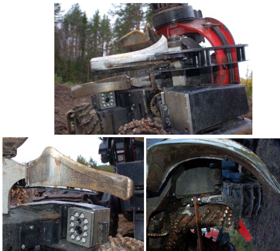
Figur 10. Bilder tagna i olika perspektiv av det skydd som utformades för att styra undan skräp som färdades under kvistknivarna.
