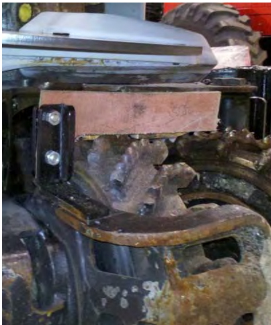
Figur 9. Närbild av skydd i form av stänklapp monterad vid matarvals. Motsvarande skydd fanns monterat vid den andra matarvalsens.
