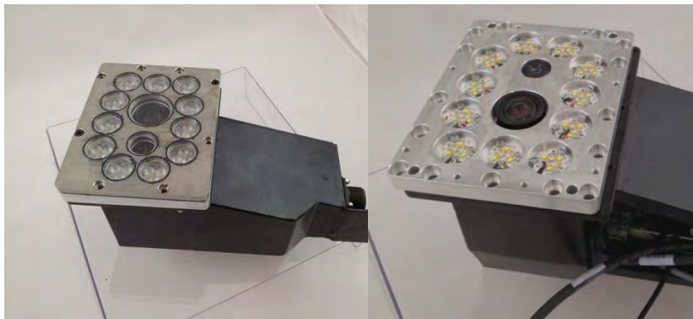
Figur 3. Det färdiga sensorsystemet med 11 LED-moduler, en kamera (stora fönstret) samt en linjelaser (lilla fönstret). En sensor för vardera höger respektive vänster sida. I höger bild är sensorns yttre skyddsglas demonterat.
