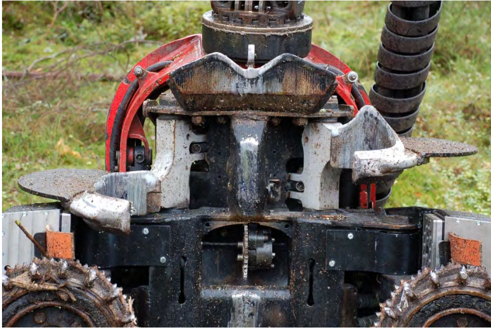
Figur 2. Bild av sensorernas placering i aggregatet vilken illustrerar att avståndet mellan kvistkniv och sensor skiljer sig åt för vänster respektive höger sensor.
