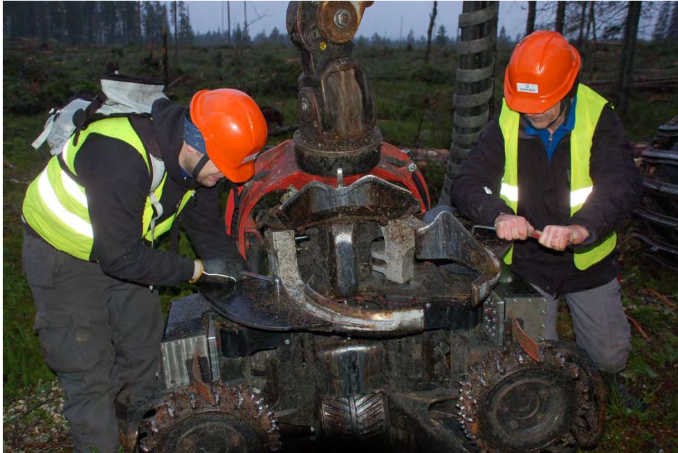
Figur 8b. Skyddsplåtarna vid de övre kvistknivarna var konstruerade för att möjliggöra ett snabbt byte under testerna.
