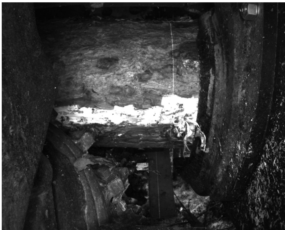
Figur 21. Exempel på levande bark/ved som färdats innanför de övre rörliga kvistknivarna.
