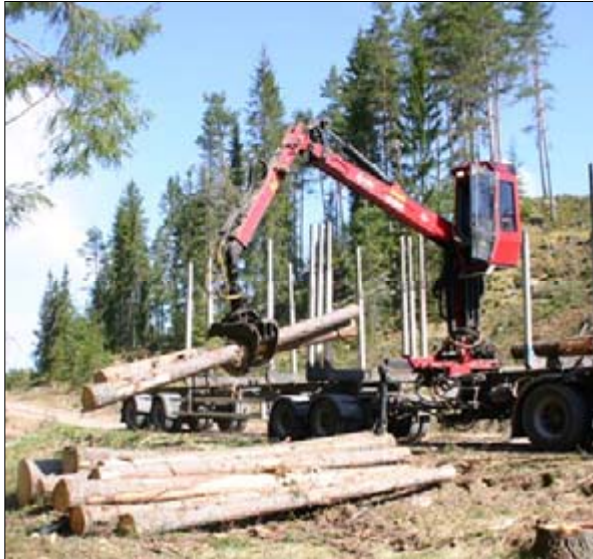
Figur 2. Rundvirkesfordon utrustad med kranpetsmonterad lastindikator.
