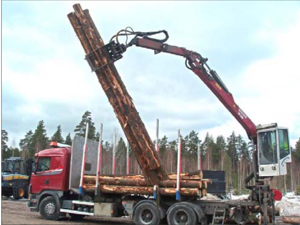
Figur 8. Mycket stark sidoblastning, förekommer ej vid normal hantering av lasten.
