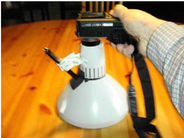
Figur 1. Tillfällig konstruktion för att fotografera märkta stockars kapsnitt. Överst kamera och till vänster en laser i form av en penna. I tratten finns också ett IR-filter.
