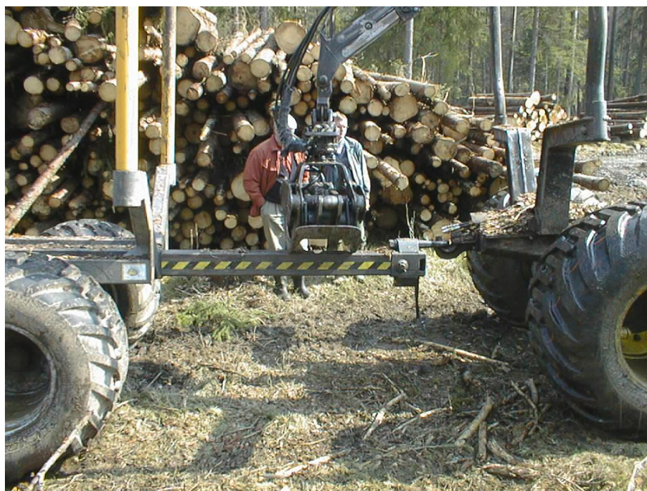
Figur 2. Hydraulisk utskjutning och indragning av vagnen. Foto: SkogForsk.
