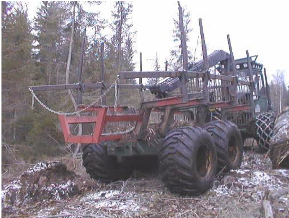
Figur 1. Påbyggnad och förlängning av skotaren.
