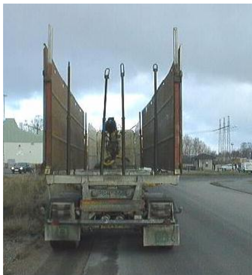
Figur 9. Ekipaget har täckt botten och sidor ingen bakstam varken på bilen eller på släpet.
