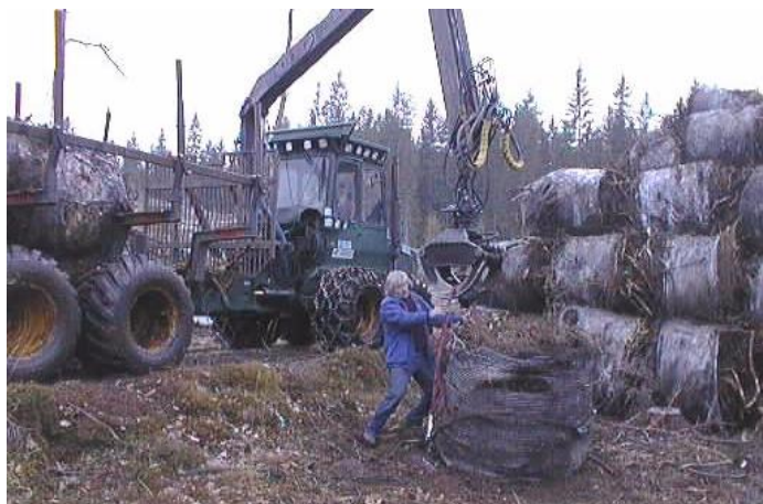
Figur 6. Applicering av våg och sling på balen som skall vägas.
