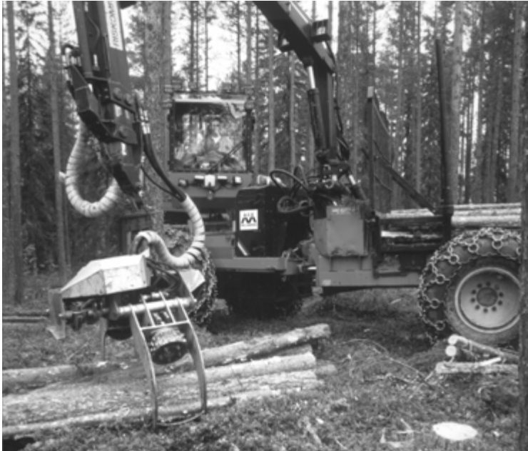
Figur 2. Pogen eller Hemek 840, en ny drivare för gallring och medelgrov slutavverkning. Foto: Hemek AB.
