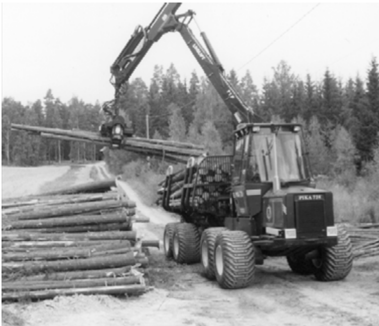
Figur 3. Pika 300 på skotaren 728T, en finsk drivare för gallring. Foto: Tillverkaren.
