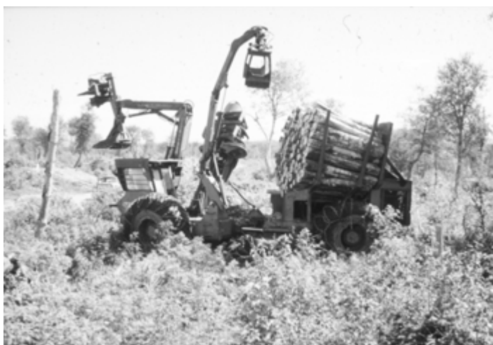
Figur 1. Koehring Shortwood Harvester. En klassisk kanadensisk drivare från 70-talet.
