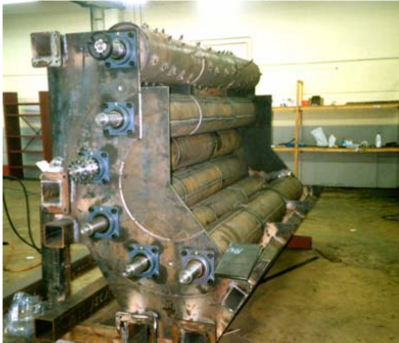
Figur 6. WWPs komprimeringsutrustning under konstruktion. Bilden visar halva komprimatorn.
