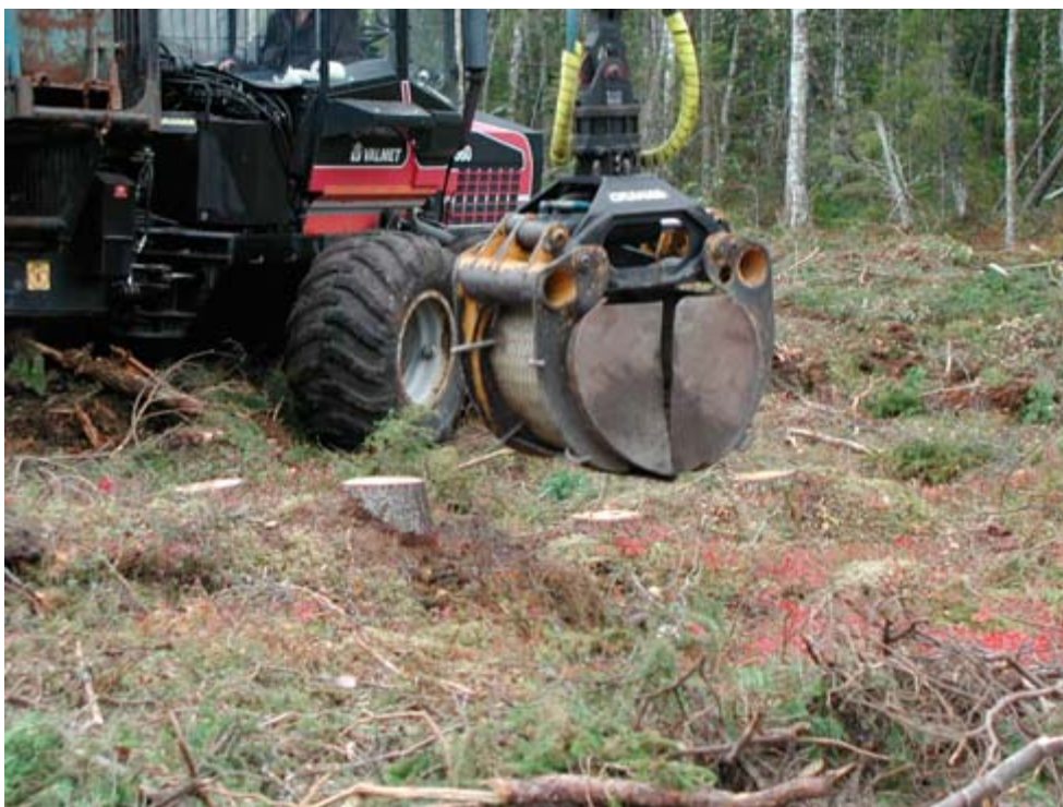
Figur 5. Virkesgripen konverterad till gripskopa. Observera att skopan är bultad till gripen för att snabbt kunna demonteras.
