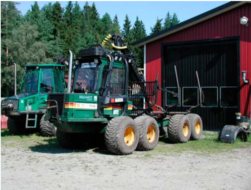
Figur 2. I det inledande försöket vid Knuters användes en Brunett Mini som basmaskin.
