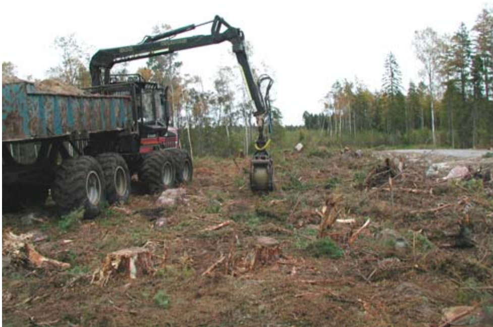
Figur 4. Studiemaskinen, en Valmet 860 skotare med en Cranab 800 kran på vilken ett modifierat bergflak monterades.
