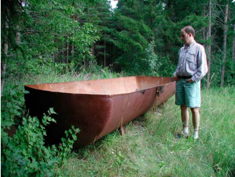
Figur 3. Det lastflak som användes monterat på en Bruunett Mini vid studien i Knuters, en kluven oljetank om ca 5 m 3 .
