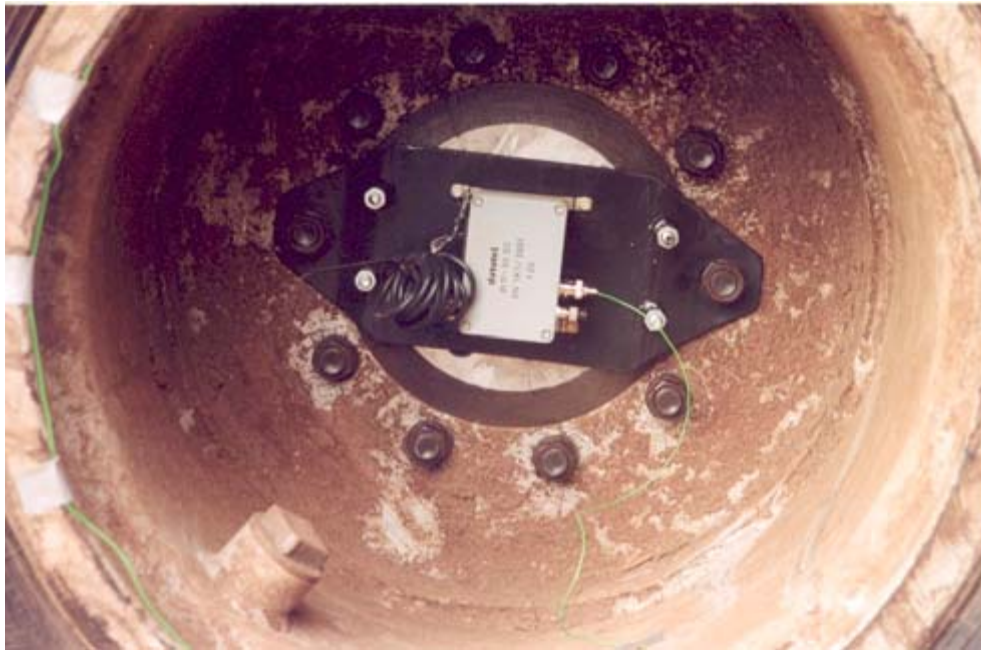
Figur 2. Momentgivare på hjulaxel.
