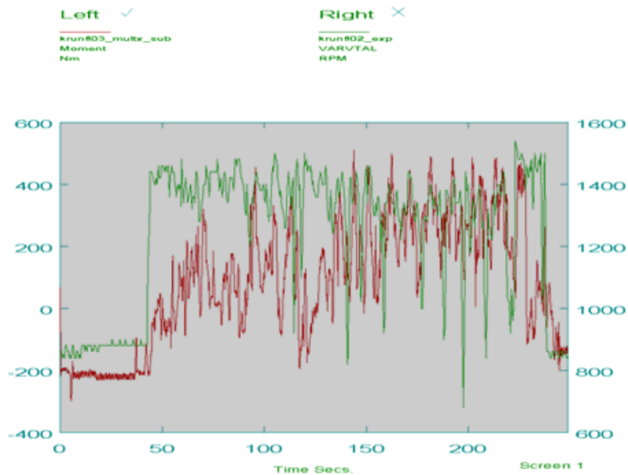
Figur 13. Motorvarv och moment vid körning under lastning.
