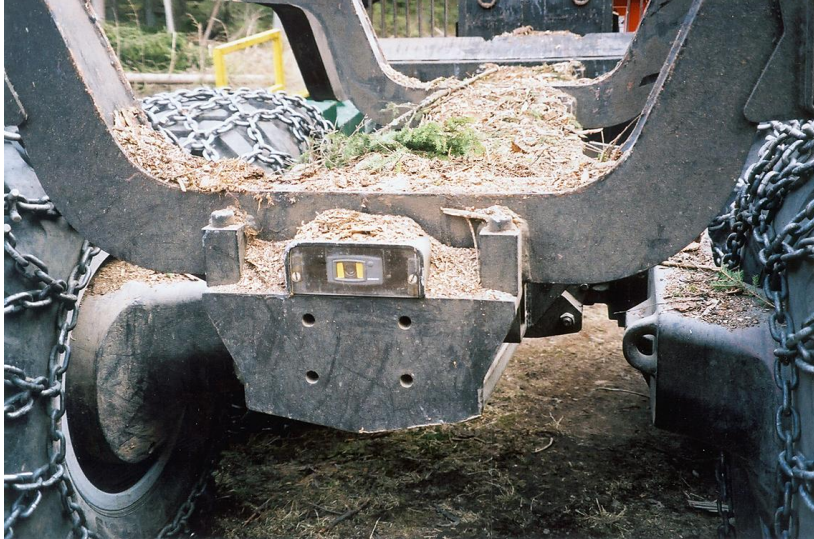
Figur 1. Kamera monterad i bakre banken, för att underlätta ansättning av skördaraggregatet på stickvägstråden.
