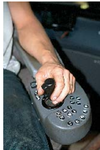
Figur 7a och b. Till vänster minispak. Till höger Swelogs lösning för trötta handleder. Foto: Lars Davner, Skogen
