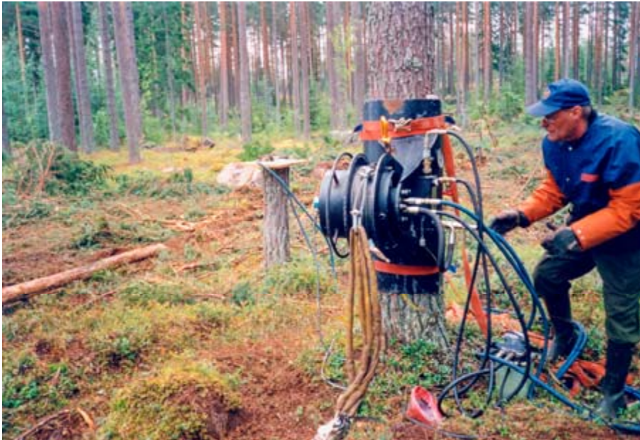
Figur 5. Bromsvinsch med kraftgivare nedtill i bilden och bromsreglaget på stubben till vänster.
