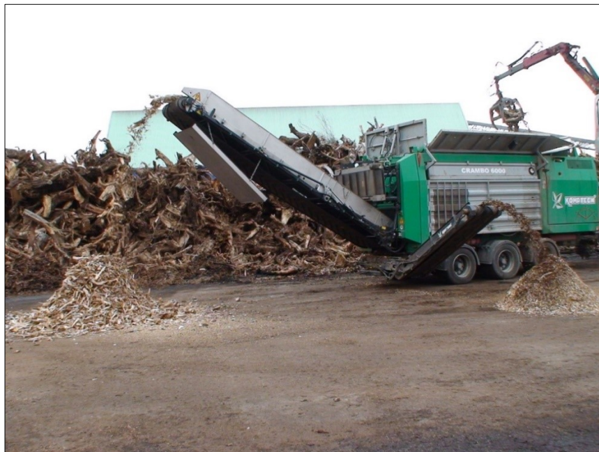
Figur 5. Crambo 6000 vid värmeverket i Värnamo. Acceptflis till vänster och utsållad reject till höger.
