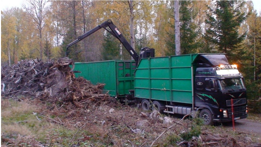
Figur 6. Grotbil med förstärkta plåtsidor lastar stubbdelar för vidaretransport till värmeverk.
