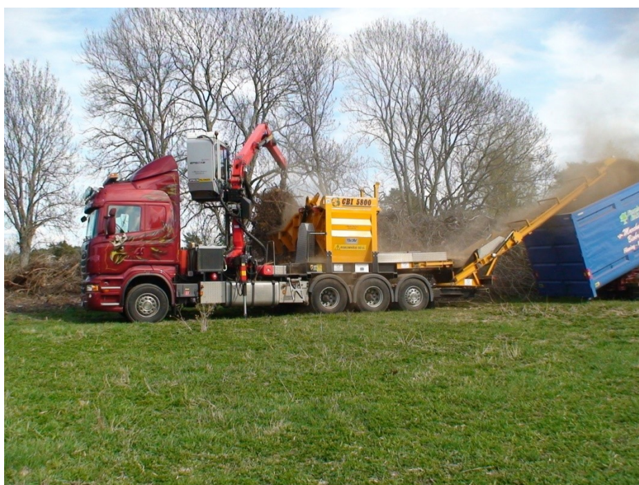
Figur 1. En Scania R620 med CBI 5800 höghastighetskross. Krossen drivs av lastbilsmotorn.
