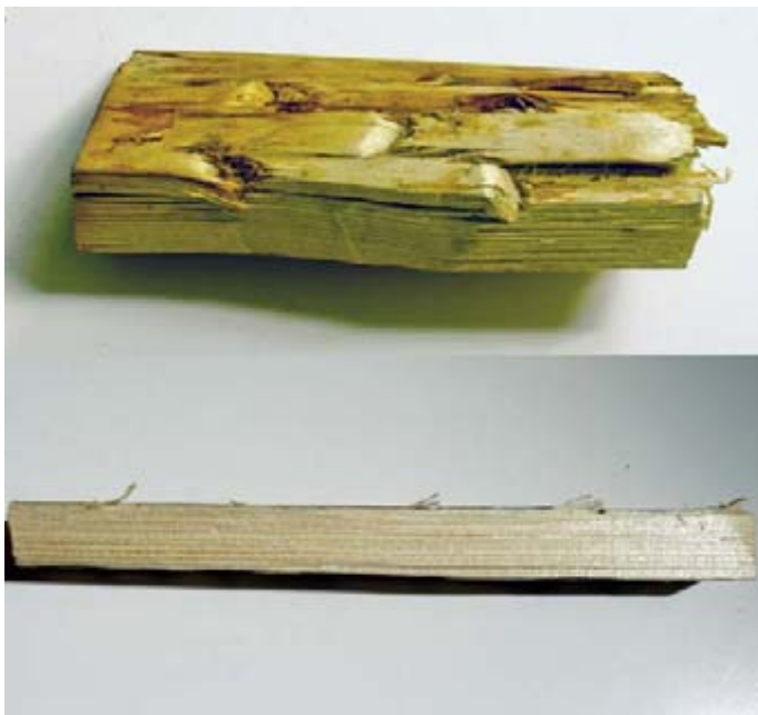
Figur 5. Skada från stålvals överst och från gummivals underst.
