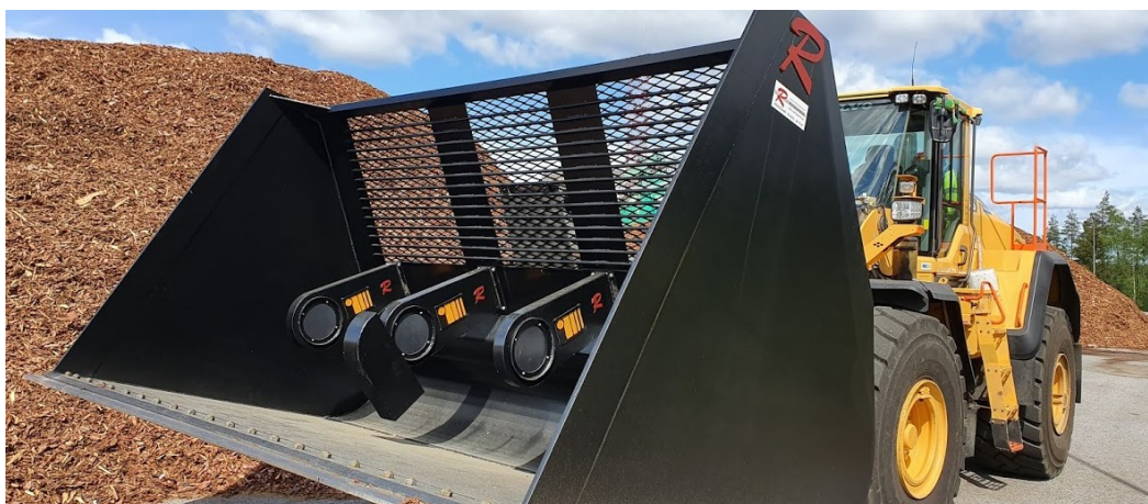
Figur 3. Lastmaskin med mätskopa för integrerad mätning samtidigt som flis hanteras. Foto: Daniel Andersson, Radarbolaget
