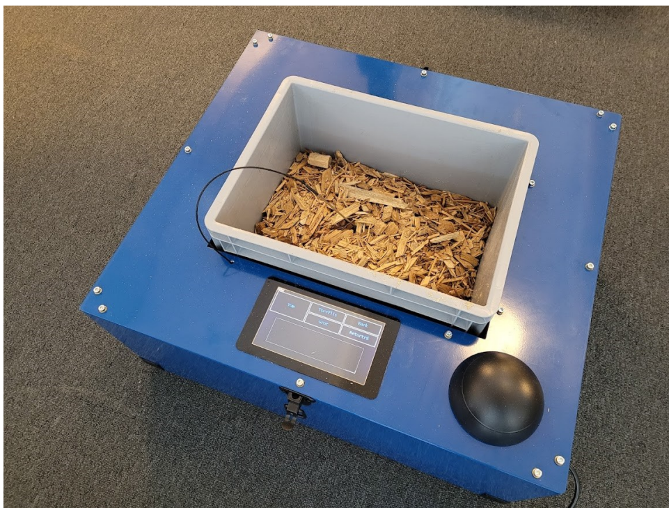
Figur 4. Mätlåda för snabb stickprovsmätning av bränsleflis. Foto: Patrik Ottosson, Radarbolaget
