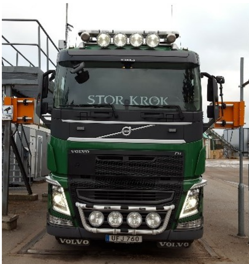
Figur 2. Mätning av inkommande flisbil med sändare och mottagare på var sida om bilen. Foto: Patrik Ottosson, Radarbolaget
