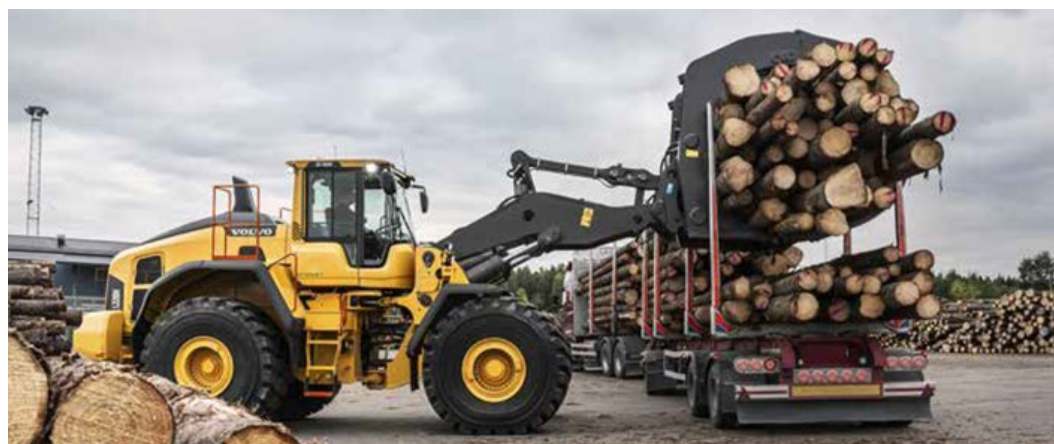
Figur 7. L180 med rundvirkesgrip motsvarande den i Scenario 4. Foto: Volvo CE.
