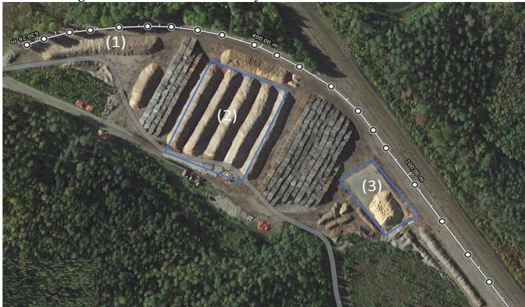
Figur 4. Flygfoto av terminalen för fallstudien. Stickspåret har ritats in med vitt och asfaltsytorna med blått. I övre vänstra hörnet kommer material in med lastbil och strax under nedre högra hörnet finns järnvägsanslutningen mot huvudspåret. Nedanför den större asfaltsytan (2) finns mätplats och uppställningsplats för maskiner. Huvudytorna för flis har numrerats. Foto: Google Maps.
