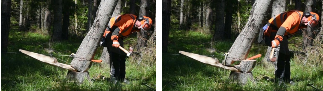
Figur 27. Skida i trä precis när Trappa ner släpper. I detta fall orkade inte vinschen på en fyrhjuling lossa utan kilen fick hjälpa till. För att säkra att stammen landar rätt på skidan och inte glider av bör det finnas elastiska stroppar och/eller vassa piggar.
