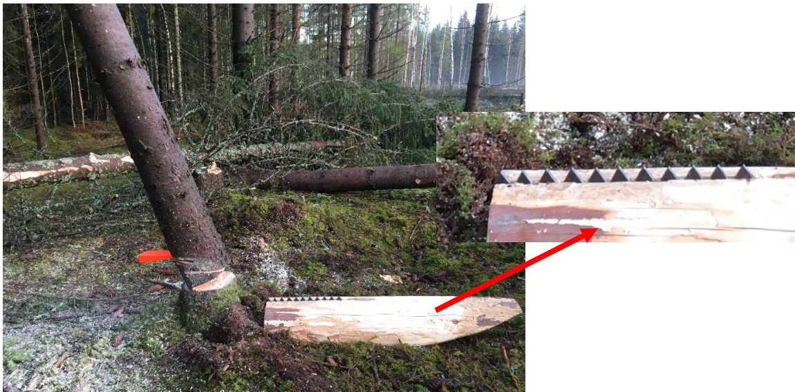
Figur 22. Trappa ner med skidan placerad. Observera "drakryggen", ett plattjärn med vassa piggarna som ligger i ett sågspår.
