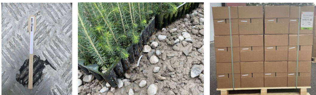
Figur 2. Bilder på RFID-etiketterna. Till vänster ”glasspinnen” som vi fäste etiketten på, i mitten en smutsig kassett som det var svårt att fästa på och till höger etiketter på kartonger på en pall.
