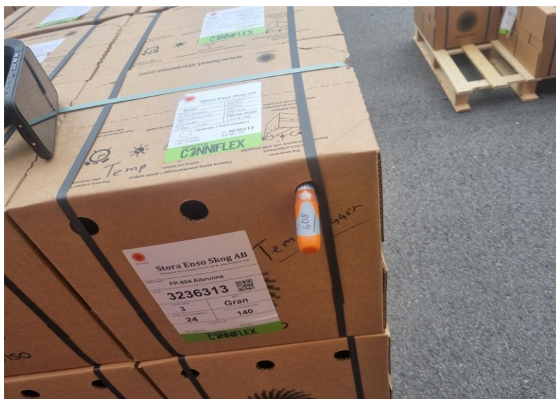
Figur 6. Loggarna placerades i lådorna genom lufthålen.
